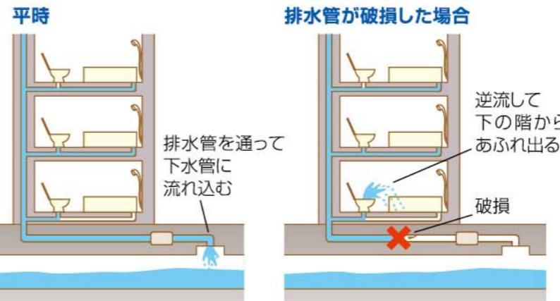
災害によって、排水管が破損するとトイレを使った際に、1階など下層階で汚水が逆流し、あふれ出ることがあります。
